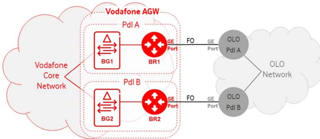
Figura 1: interconnessione rete Vodafone con doppio Border Control Functions per singola area GTW VOIP VF.
